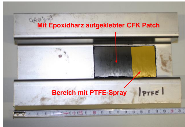
Abb. 4: Hutprofil mit aufgeklebtem CFK Patch und eingebrachtem Kissing Bond
