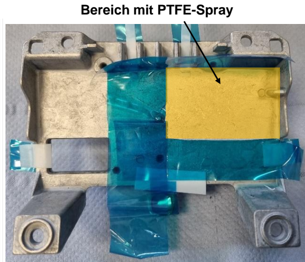
Abb. 5: Aluminiumgehäuse mit eingeklebter LED-Platine und Kissing Bond
