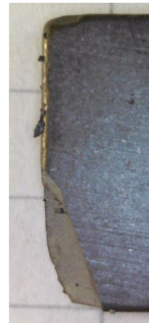
Äußerer Defekt (Absplitterung)
