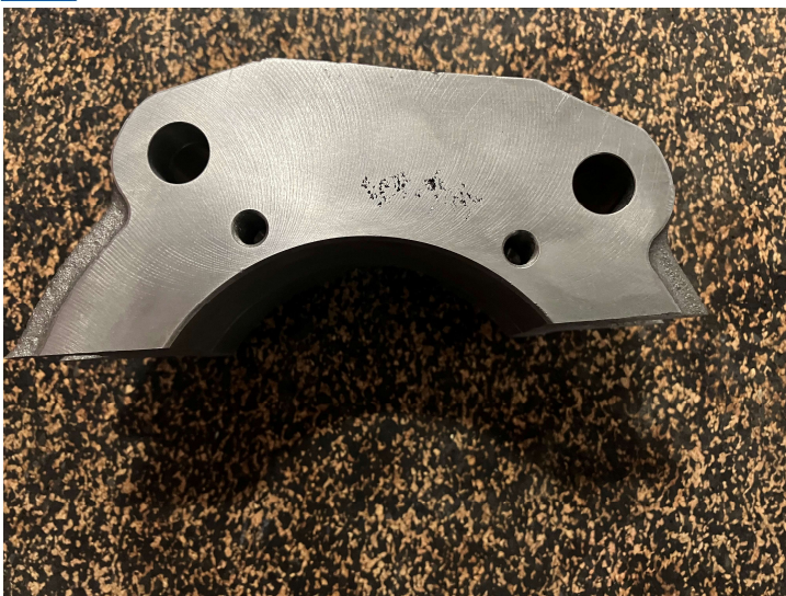
Testteil Guss mit porigen Anzeigen
