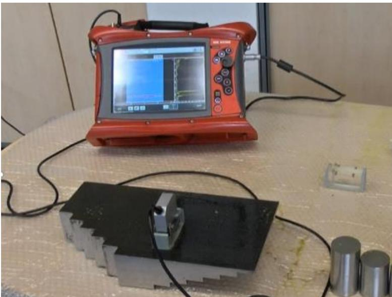
Für die Ultraschallprüfung in FMC/TFM Technik verwenden wir ein Ultraschall Prüfgerät GEKKO der Fa. M2M (Eddyfi), eine 64 Elemente Linear Array und einen Plexiglasvorsatz.
