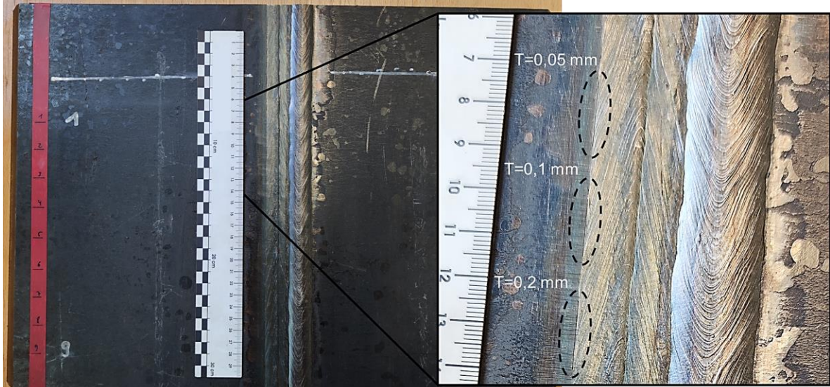
Abb. 5. Stumpfnah mit rissähnlichen Nuten in der Wärmeeinflusszone und detaillierte Darstellung der Nuten mit Tiefen von 0,05 bis 0,2 mm
