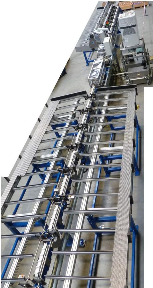
Abb. 3: Zur Stangenprüfung verwendete modifizierte Rohrprüfanlage (Durchlaufrichtung von hinten nach vorne)
