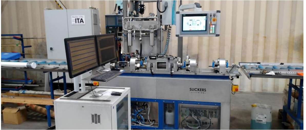
Abb. 6: flexibel aufgebaute Stangenprüflinie zur automatisierten Ultraschallprüfung von Stangen im Durchmesserbereich 4-25,4 mm Durchmesser
