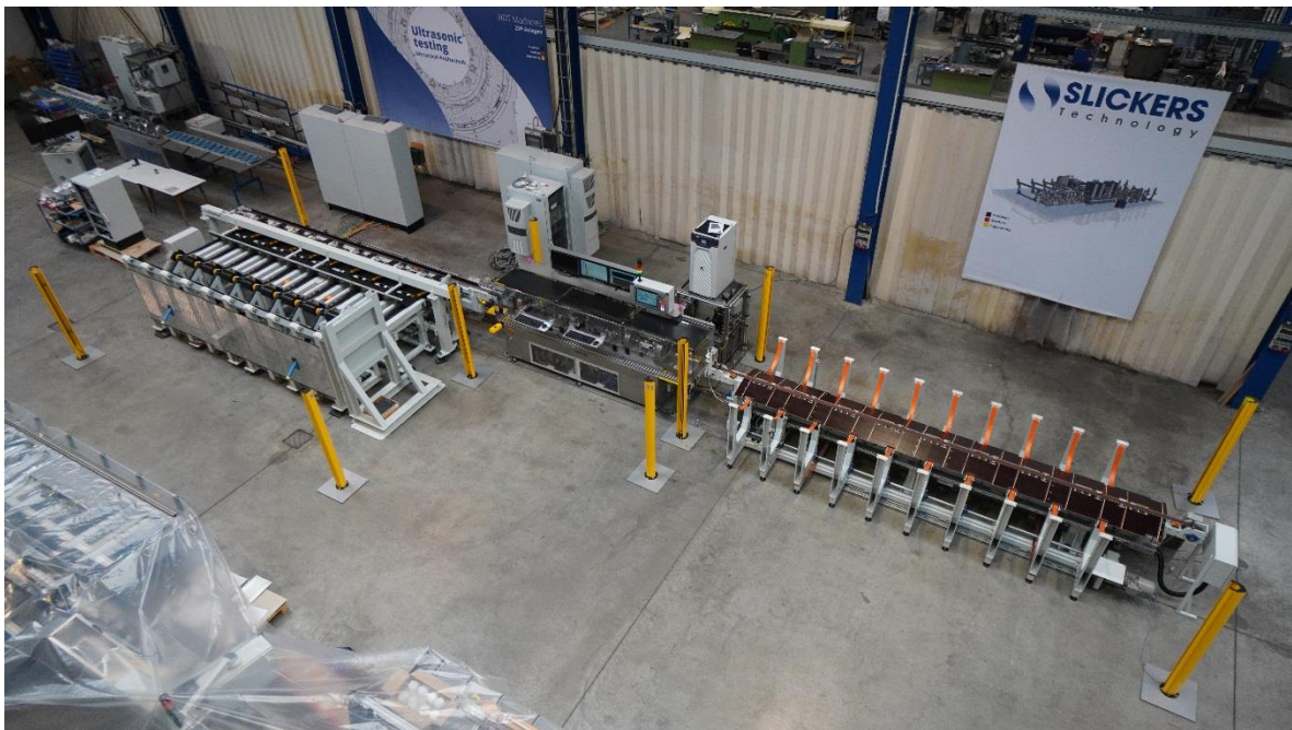
Abb. 1: Prüfanlage zur Stangenprüfung mit Wirbelstrom und Ultraschall vor der Auslieferung
