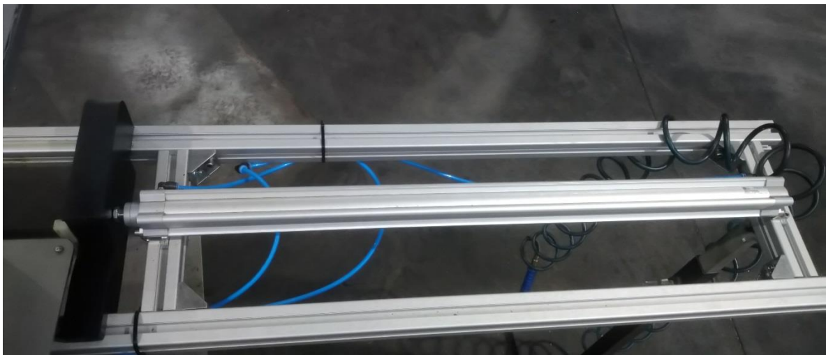
Abb. 8: Detail, pneumatischer Vorschub im Stangeneinlauf
