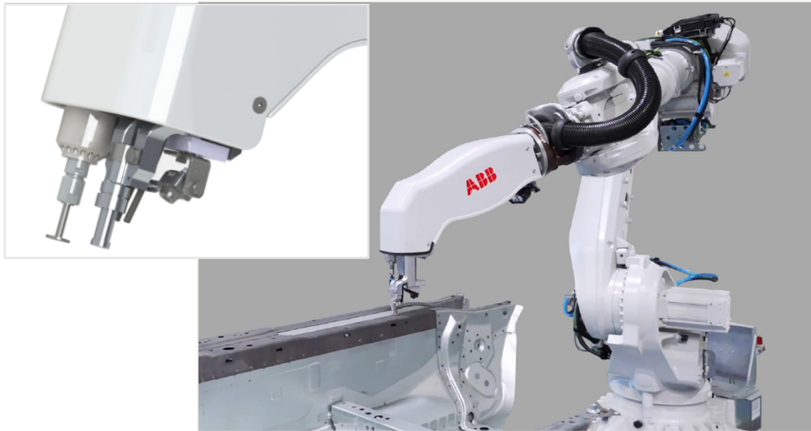
Abb. 2. Robotergestützte Schweißpunktprüfung mit PHAsis
