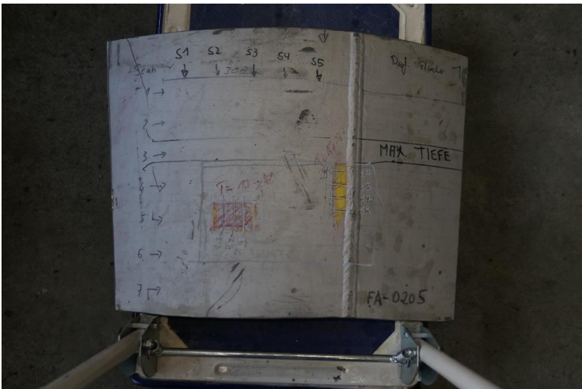
Abb. 2: Herausgetrennter Bereich zur weiteren Schadensanalyse
