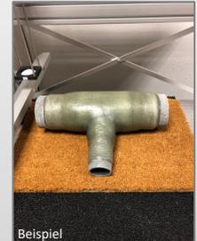
**Poster P13: Millimeterwellen lösen ein Problem bei der Wanddickenprüfung von GFK-Bauteilen mit Ultraschall**
