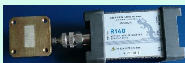
Bild 4: Messtechnik. oben: Reflektometer und Adapter auf dielektrisch gefüllten Hohlleiter, rechts: Prüfobjekt GFK-Rohrabschnitt und Laptop zur aktuellen Messwertanzeige im Smith-Diagramm (komplexe Ebene)
