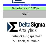
Die elektrische Leitfähigkeit und die Abhebung wirken in verschiedene Richtungen in der Impedanzebene. Der Lack erzeugt Abhebung, die Zinkschicht zusätzlich eine Leitfähigkeitsänderung.
